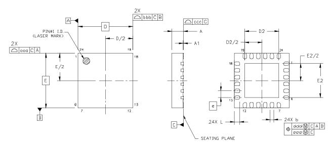
Figure 28. 24-Lead Quad Flat No-lead (QFN)
