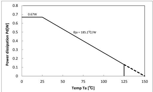
Figure 20. Power Dissipation
